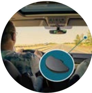
Les antennes adhésives sont généralement *low profile*, de faible épaisseur et légères pour être installées facilement et à moindre coût. De nombreuses antennes GPS sont adhésives pour faciliter l'installation sur le **pare-brise** ou le **tableau de bord** des véhicules.
