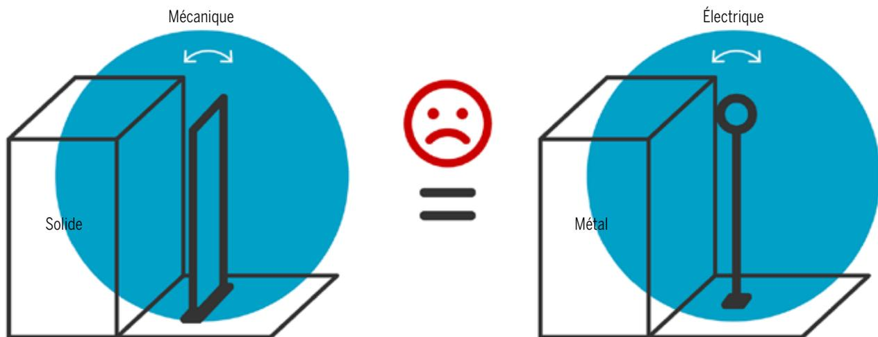
L'antenne et la lame métallique ne vibrent que si éloignées d'une masse latérale.
